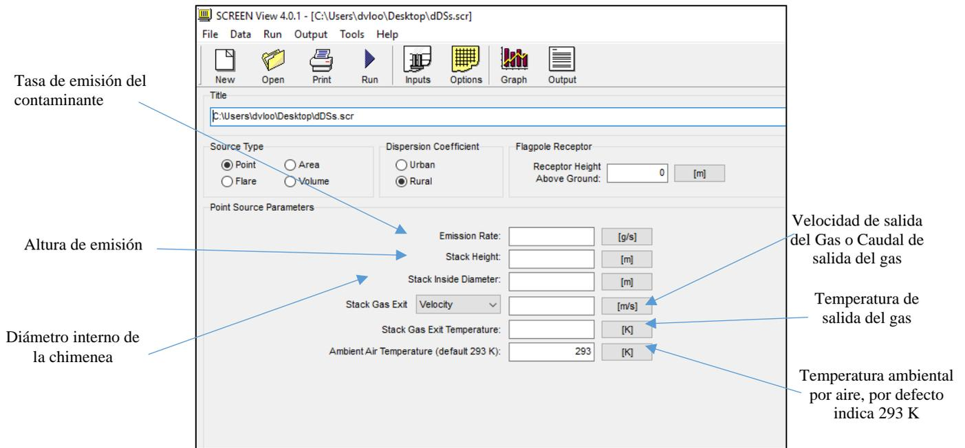
**Figura 9-3** Ventana del software Screen View para fijar los datos de entrada
