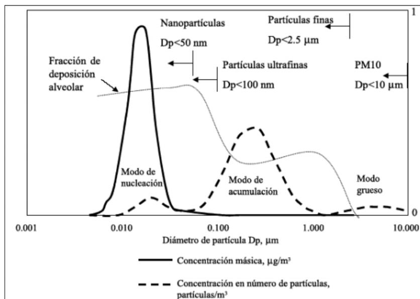
**Figura 9-1** Distribución de las partículas según tamaño y masa de un motor Diésel
